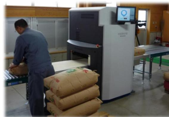
袋をベルトコンベアに載せてバーコードを読み取り、検査器で測定
